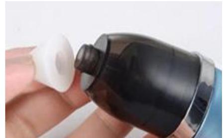
**Stellen Sie immer sicher, dass sich der Filterschwamm unter dem Sammelraum befindet. Wenn der Filterschwamm verschmutzt ist, muss er ersetzt werden. Bitte ersetzen und installieren Sie ihn wie oben beschrieben.**
